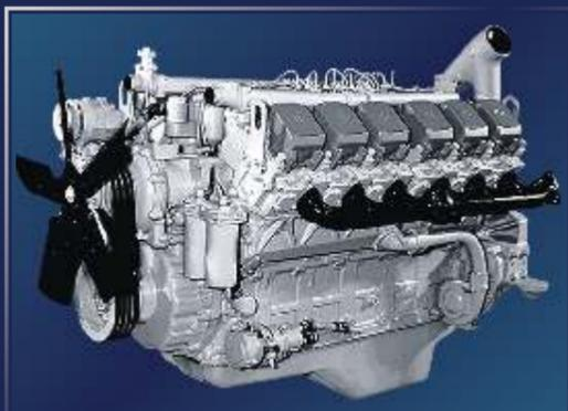
Дизельные двигатели размерности DхS=130х140 мм, с рабочим объемом цилиндров 25,86 л, 4-тактные, с V-образным расположением цилиндров, жидкостным охлаждением, непосредственным впрыском топлива.
