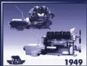
В 1947-49 гг. Ярославский автомобильный завод освоил серийный выпуск автомобильных дизельных двигателей для перспективной техники. Первыми моделями стали двухтактные 4-цилиндровые дизели ЯАЗ-204 и 6-цилиндровые ЯАЗ-206, мощностью 110-165 л.с. Семейство двухтактных двигателей выпускалось на предприятии до 1993 г.
