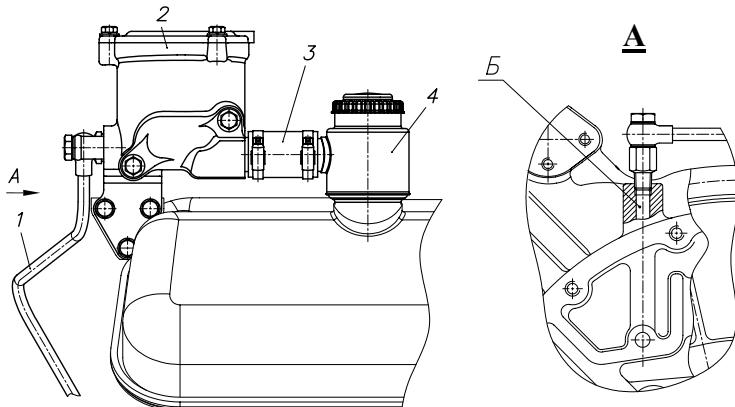
Рис. 3. Система вентиляции картера:
