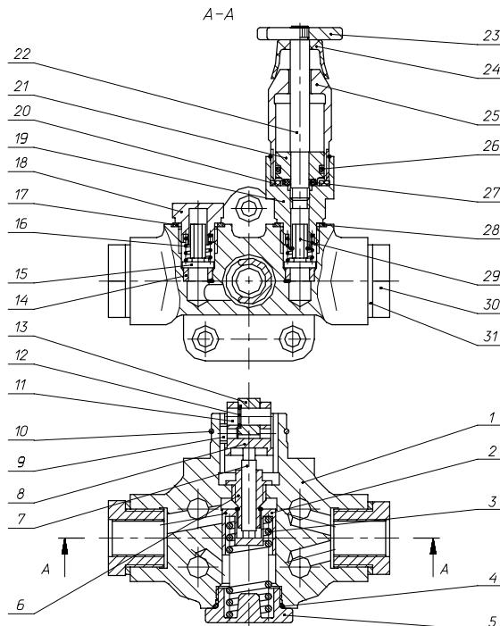
Рис. 12. Топливоподкачивающий насос:
