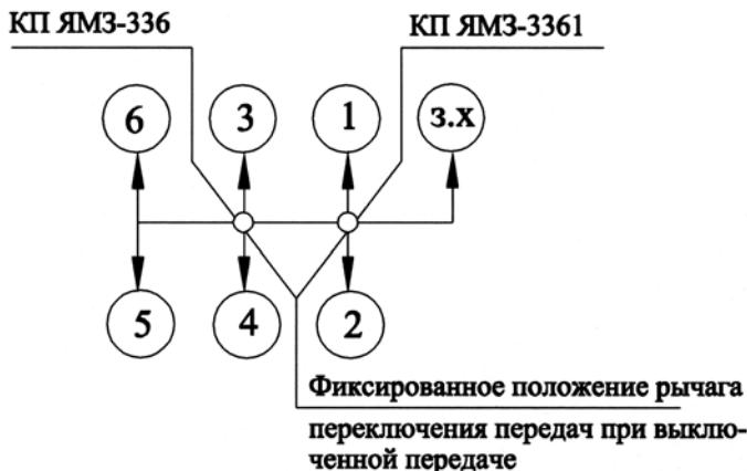
Рис. 22. Схема переключения передач КП.
