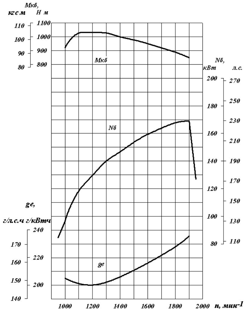
Рис. 1б. Скоростная характеристика двигателя ЯМЗ-6563.10 с КП ЯМЗ-336
