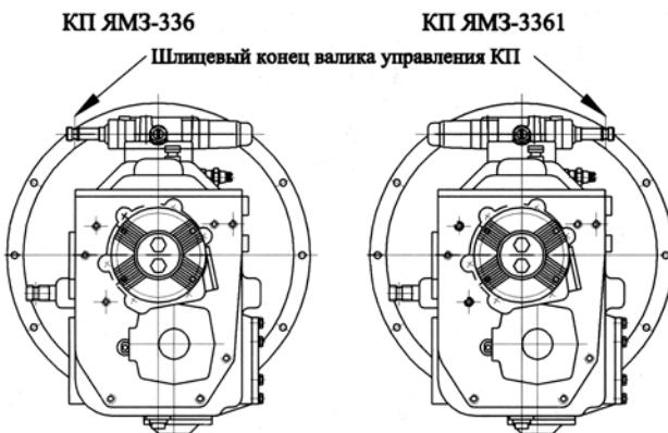
Рис. 21. Расположение шлицевого конца валика управления КП.
