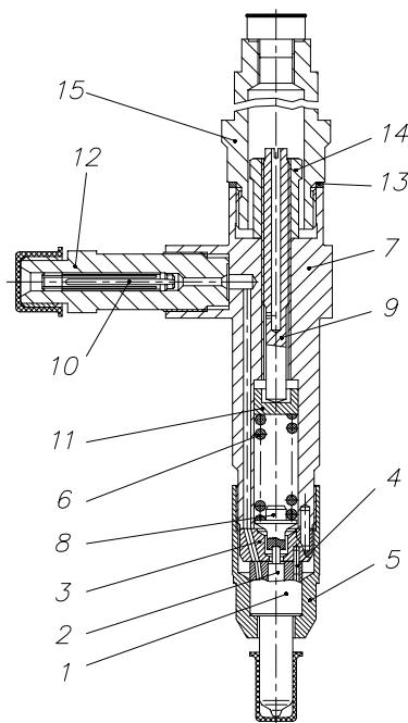
Детали форсунки собраны в корпусе форсунки 7. К нижнему торцу форсунки гайкой распылителя 5 присоединяются проставка 3 и корпус распылителя 1, внутри которого находится запорная игла распылителя 2. Взаимное расположение корпуса форсунки, проставки и корпуса распылителя определяется штифтами 4, запрессованными в проставку. Корпус распылителя и игла распылителя являются прецизионной парой.
