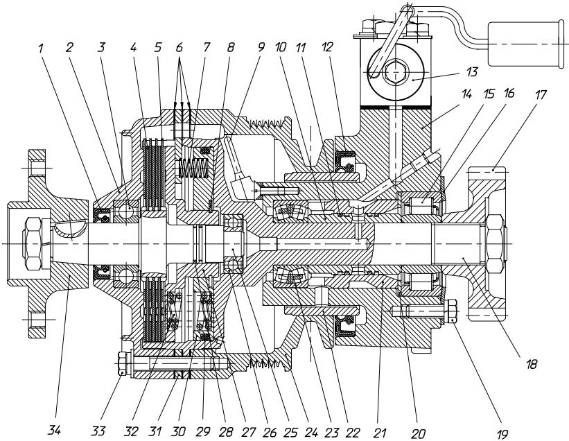
Рис. 8. Привод вентилятора:
